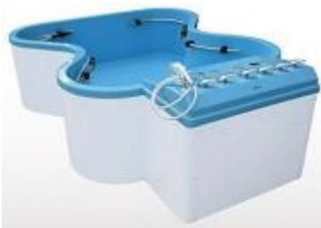
Ванна **HUBBARD** используется для лечебного массажа всего тела пациента или его частей водяной струей, направляемой под уровнем воды. Массаж можно выполнять как напорный, с применением массажного наконечника шланга, или как вихревой при переключении водяной струи в форсунки, предназначенные для вихревого массажа. Максимальный объем 1 260 л. Вес 930 кг. Размеры (д х ш х в) 2670 х 2000 х 1100
