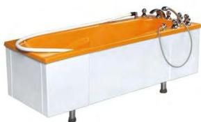
Бальнеологическая ванна **T-MP UWM** для ручного подводного массажа предназначена для проведения подводного струйного массажа и оснащена гибким шлангом со сменными наконечниками и клапаном, регулирующим давление гидромассажной струи. Идеально подходит для проведения ручного подводного массажа детей и подростков. Объем ванны 350л. Габариты: 2080 x 840 x 700мм
